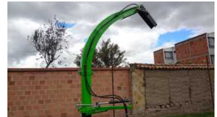
Buitrón y deflector hidráulico
